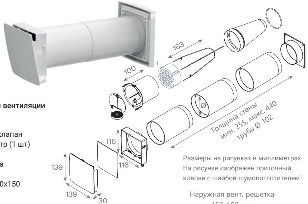
Размеры на рисунках в миллиметрах. На рисунке изображен приточный клапан с шайбой-шумопоглотителем<sup>1</sup>.
